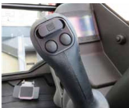
Manipolatori con comando ausiliario proporzionale o a pulsante. Possibilità di attivare il funzionamento dell'ausiliario a scatto, mediante il comando Detent Mode.
