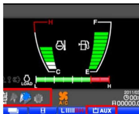
Le configurazioni memorizzate sono richiamabili rapidamente dal menu iniziale premendo il tasto AUX, lo strumento selezionato apparirà a colori. Selezionando il simbolo scelto, il sistema darà la portata di olio memorizzata.
