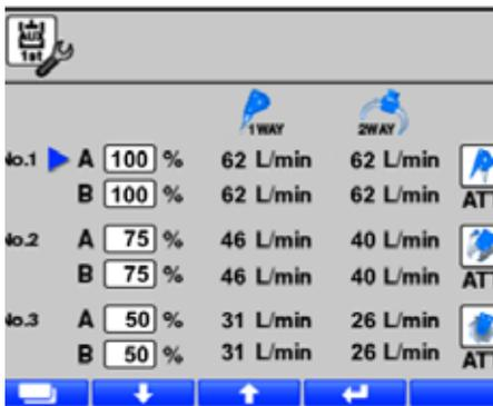
Tramite il computer di bordo è possibile aumentare o diminuire la quantità di olio sulla prima e seconda linea ausiliaria. È possibile memorizzare tre configurazioni per il 1° ausiliario.
