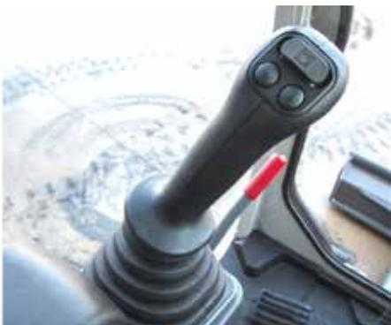
Manipolatore con comando ausiliario proporzionale o a pulsante. Possibilità di attivare il funzionamento dell'ausiliario a scatto.
