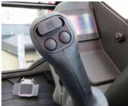
Manipolatore dx con clacson e deceleratore a pulsante. Con il grilletto posto dietro è possibile attivare la seconda velocità.
