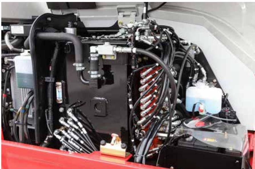
Il TB240 è caratterizzato da ampi cofani laterali che si aprono ad ali di gabbiano e consentono un facile accesso a tutti gli elementi idraulici della macchina: sono collocati ad altezza uomo, come il distributore, il serbatoio olio idraulico, il radiatore, ecc.... Nella parte inferiore della torretta i tappi permettono di effettuare in maniera rapida e pulita lo spurgo dell'olio idraulico, dell'olio motore e del serbatoio gasolio.
