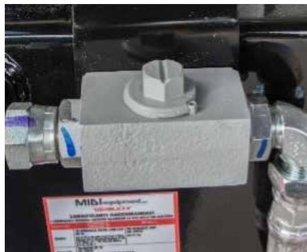
Rubinetto selettore impianto ausiliario doppio effetto (pinza, trincia) o singolo effetto (martello).
