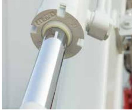
Cilindri idraulici ammortizzati dotati di guarnizioni antipolvere.
