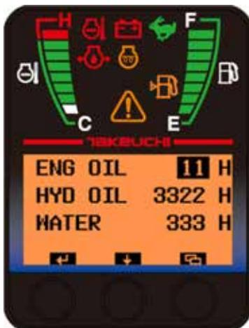
Computer di bordo con contatore, manutenzione e spia di allarme per:
