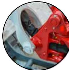
Le tubazioni idrauliche passano all'interno del braccio per ridurre il rischio di rotture. Sistema a culla per accompagnare le tubazioni idrauliche senza stress durante il movimento del braccio.
