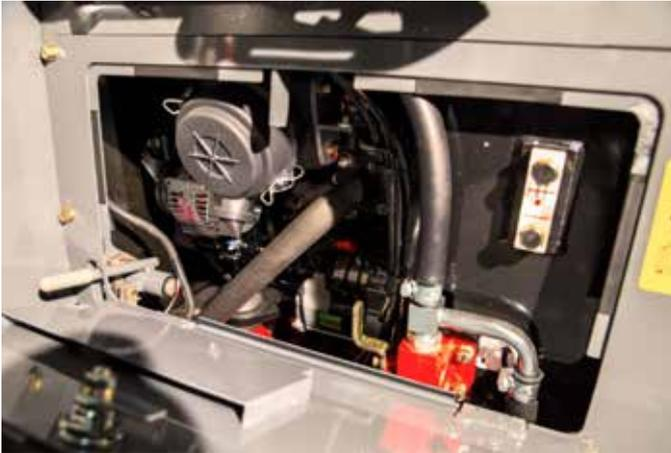
Sotto il sedile dell'operatore si trova la spia per il controllo del livello olio idraulico, il selettore singolo / doppio effetto della linea ausiliaria e il filtro dell'aria con l'indicatore dello stato di intasamento.
