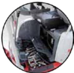
La pompa a portata variabile regola, gestisce la portata e la pressione in funzione del carico sul sistema idraulico, per incrementare la forza di scavo e ridurre i tempi ciclo.
