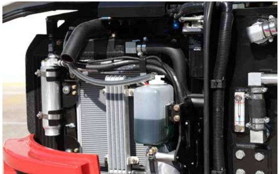
Radiatore comodo e semplice da smontare, le operazioni di pulizia della batteria alettata sono facili da eseguire: una pulizia costante garantisce uno scambio termico più efficiente.
