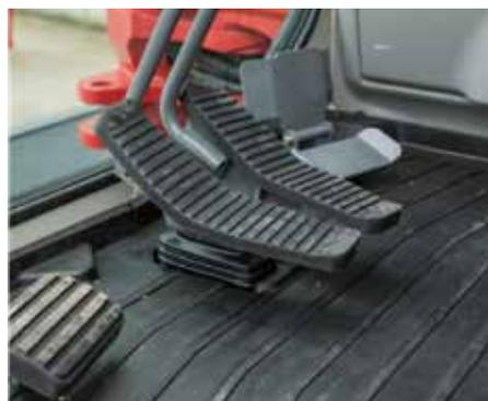
Controllo avanzamento mediante le due leve di traslazione e i 2 pedali integrati, dotati di rivestimento antiscivolo.
