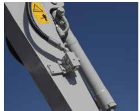
Rubinetti all'uscita dell'impianto ausiliario per evitare spillamenti e perdite di pressione in fase di installazione / disinstallazione delle attrezzature.
