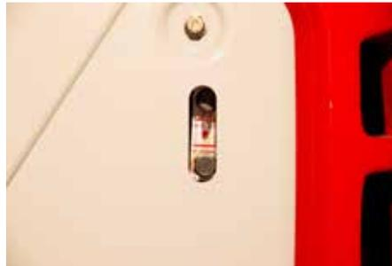
Controllo del livello olio idraulico.
