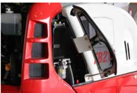
La botola laterale garantisce un comodo accesso per la pulizia del radiatore, per il riempimento del serbatoio olio idraulico e del liquido refrigerante.
