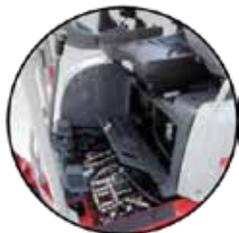
La pompa a portata variabile varia la portata e la pressione in funzione del carico sul sistema idraulico, per incrementare la forza di scavo e ridurre i tempi ciclo.
