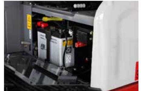
Batteria posizionata nel vano sotto il sedile.
