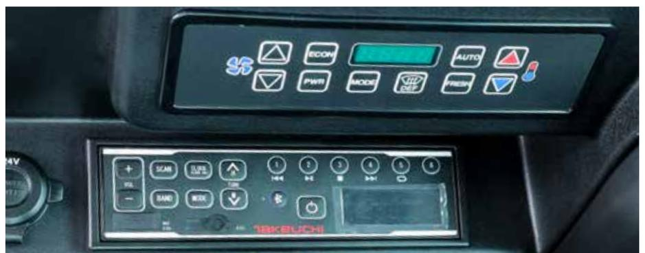
Radio FM/AM con AUX-IN resistente a polvere e acqua.
