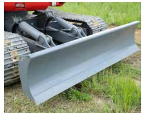
Lama dozer ridisegnata e rinforzata per facilitare la movimentazione della macchina in cantiere.
