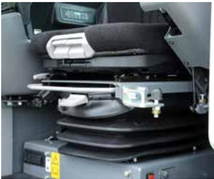
Il sedile pneumatico prevede la funzione riscaldamento e 9 regolazioni.
