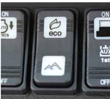
La macchina è configurata per lavorare in modalità POWER di default, in ECO mode si ha un risparmio di carburante del 15%. La modalità MOUNTAIN (da usare sopra gli 800m di altitudine) riduce il carico motore dovuto all'aria rarefatta.
