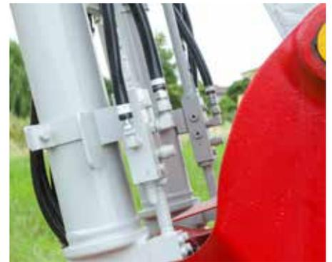
Valvole di sicurezza anticaduta su braccio e avambraccio con allarme di sovraccarico attivabile in cabina.
