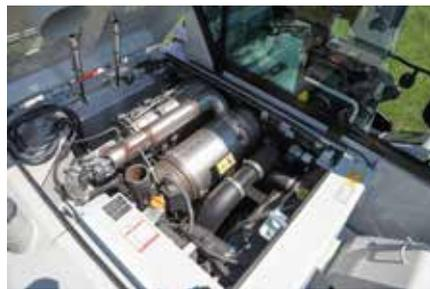
Motore conforme a EU Stage V / EPA Tier 4 - Turbocompresso con trattamento post scarico DOC + DPF + SCR
