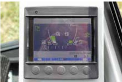
Display multi-funzione a colore da 5,7" per controllo parametri macchina e motore.
