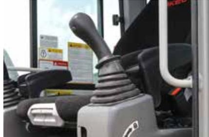
Comandi idraulici per avere un feedback reale di lavoro. Richiedono uno sforzo limitato, sono lisci e permettono all'operatore di controllare il veicolo in modo facile e preciso per lavorare in tutta sicurezza.
