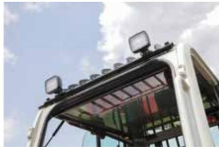
2 luci cabina a LED e 1 posteriore per agevolare carico e scarico anche in condizioni di scarsa visibilità.
