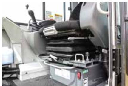
Sedile standard a sospensione regolabile in base al peso dell'operatore con schienale alto e poggiatesta, braccioli regolabili in altezza e cintura di sicurezza avvolgibile.
