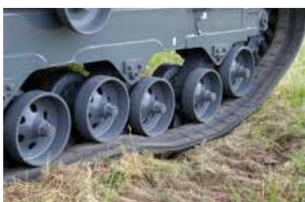
Rulli con brandeggio permettono una perfetta adattabilità sul terreno irregolare o sconnesso senza rovesciarsi. Il TCR50-2 è adatto a tutte le applicazioni che necessitano di bassa pressione al suolo, al trasporto di carichi pesanti e per operare su superfici morbide come neve, sabbia, fango e ghiaia.
