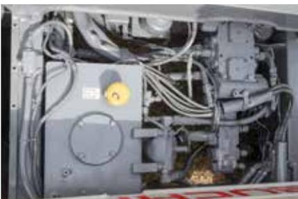
Impianto idraulico con più pompe indipendenti per assicurare movimenti fluidi e combinati in ogni situazione.
