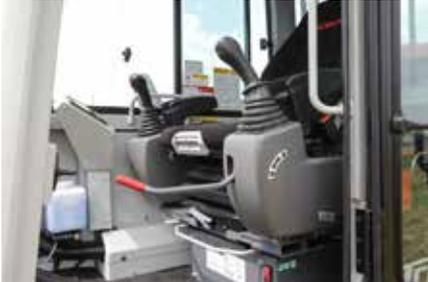
Leva di sicurezza per evitare un azionamento accidentale degli organi idraulici del dumper.
