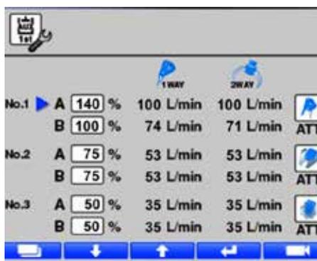
Tramite il computer di bordo è possibile aumentare o diminuire la quantità di olio al sistema ausiliario. È possibile memorizzare tre configurazioni per il primo ausiliario.
