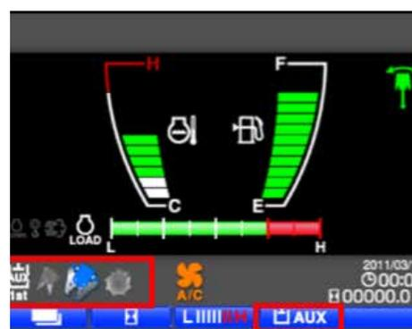
Le configurazioni memorizzate sono richiamabili rapidamente dal menu iniziale premendo il tasto AUX. Selezionando il simbolo scelto, il sistema darà la portata di olio precedentemente memorizzata (di default: No.1 100%; No.2 75%; No.3 50%)
