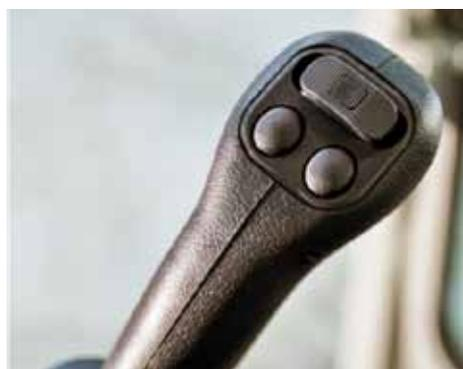
Manipolatori con attivazione delle linee idrauliche ausiliarie di tipo ON-OFF e proporzionale.
