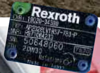
**DOPPIA POMPA A CILINDRATA VARIABILE REXROTH** Nel reparto pompe la protagonista è una doppia pompa a portata variabile da 2 x 60,5 litri/min per 24 MPa di pressione massima. In serie è montata una prima pompa a ingranaggi (P3) da 44,7 litri/min per rotazione e lama, quindi la P4 per pilotaggi. L'high flow su Aux 1 da 105 litri/min è ottenuto sommando alla P1 la portata di P3 per una pressione massima di 20,6 MPa.
