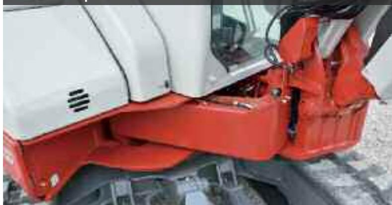
**BARICENTRO DELLA GAMMA FR** Il TB257FR va a sostituire il modello di prima generazione TB153FR. A dispetto della nomenclatura, il peso operativo del nuovo modello (5.970 kg) è superiore di soli 100 kg, ma le prestazioni sono aumentate in modo deciso grazie al motore 32% più potente, alla forza di trazione
