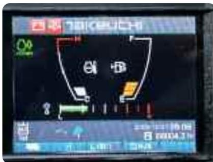
**UNA GRAFICA, TRE FUNZIONI** L'indicatore del regime motore a barra diventa anche testimone di intasamento dpf e di sovraccarico.
