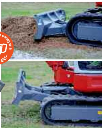
**LAMA SCATOLATA** Tutta la carpenteria del TB257FR è tagliata e saldata direttamente da Takeuchi e la lama non fa eccezione. Disegno e fattura puntano a distribuire in modo uniforme le sollecitazioni sui longheroni scatolati con traversa antitorzione e d'azionamento tubolare. Ottimo anche l'incernieramento in linea con il sottocarro per non penalizzare la luce a terra.
