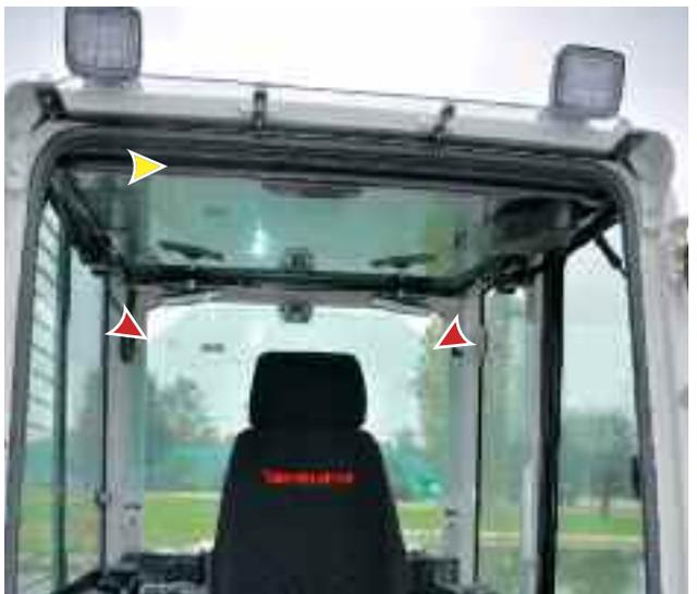
**VISIBILITÀ E PARABREZZA A SCOMPARSA** La nuova cabina a 5 montanti ha una superficie vetrata importante. Al riguardo il parabrezza è in due pezzi (60-40): quello superiore con doppi specchi retrovisore scompare sopra la testa dell'operatore, mentre la parte inferiore si sfilata e fissa alle spalle del sedile in parallelo al lunotto.
