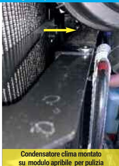
Condensatore clima montato su modulo apribile per pulizia
