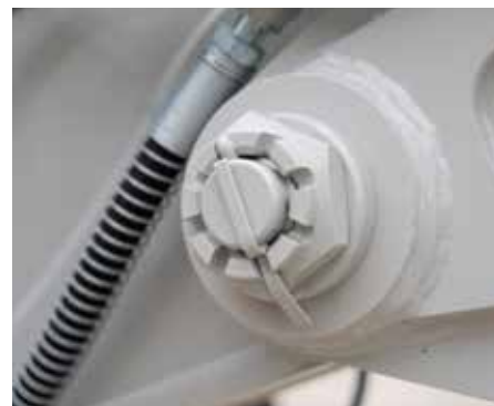
Bloccaggio perni con sistema "recupero di gioco" per allungare la vita di perni e boccole.
