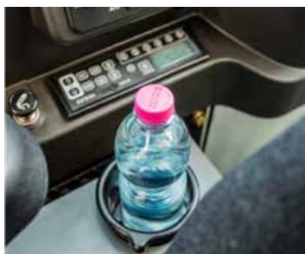
Porta bevande con riscaldamento o raffreddamento integrato: con la rotazione della ghiera è possibile regolare il flusso di aria.
