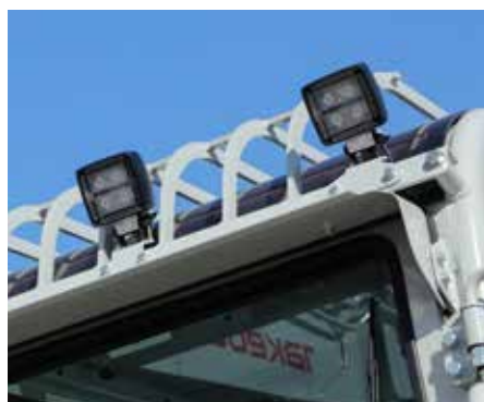
Fari da lavoro a Led per facilitare le operazioni di scavo in condizioni di scarsa visibilità: 2 fari laterali - 2 fari sul braccio scavo - 2 fari sopra cabina - 1 faro da lavoro frontale.
