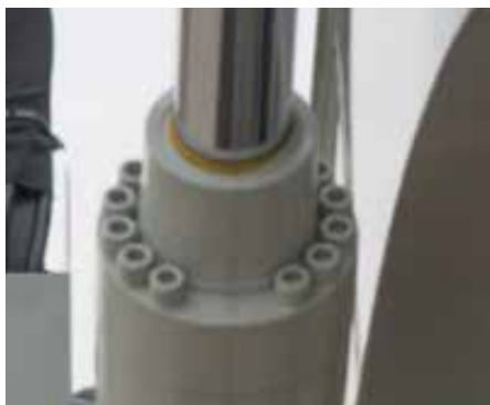
Cilindri ammortizzati con guarnizioni antipolvere.
