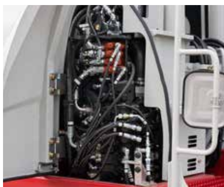
Distributore modulare Kyb con valvole anticavitazione e pompe Kawasaki.
