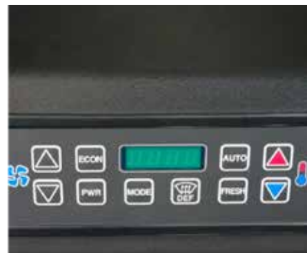
Aria condizionata con pannello di controllo e regolazione automatica della temperatura interno cabina.
