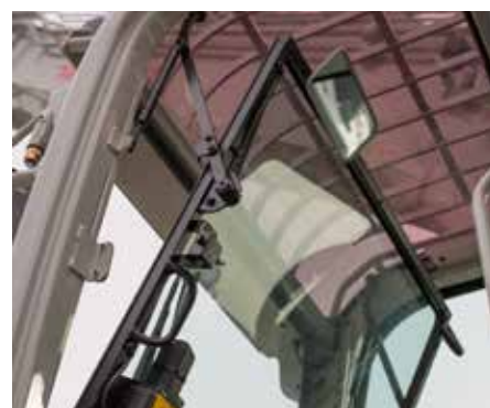
Vetro frontale con apertura a scomparsa. Vetro inferiore removibile con supporto dietro al sedile.
