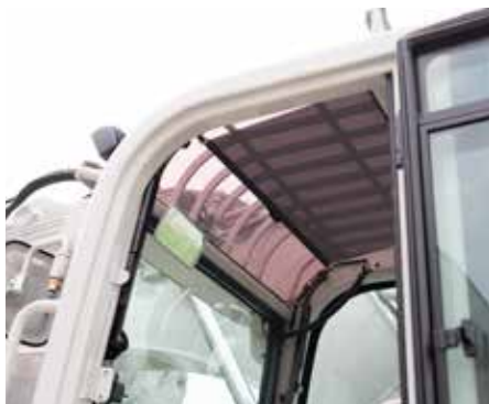
Ampio tettuccio trasparente con telo parasole.
