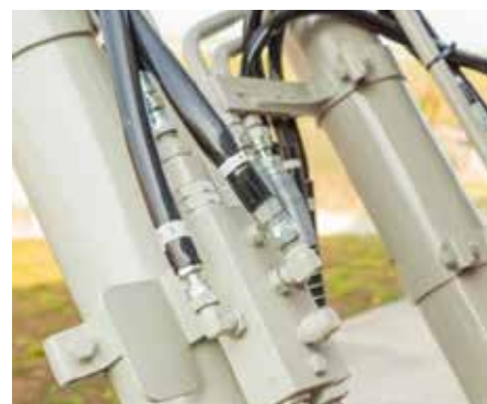
Valvole di sicurezza anticaduta su braccio e avambraccio con allarme di sovraccarico attivabile in cabina.
