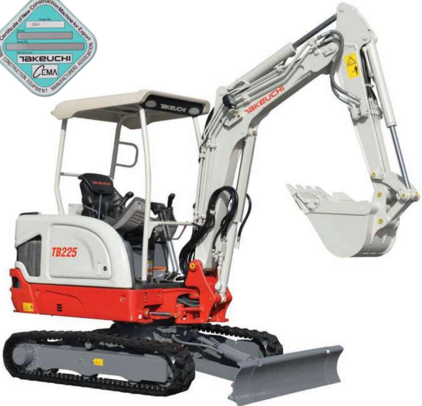
Takeuchi amplia la propria gamma con l'escavatore compatto TB225 con massa operativa 2400 kg. Disponibile sia nella versione Cabina, sia nella versione Canopy, questa macchina è una combinazione di eccellente qualità costruttiva e prestazioni. In entrambe le versioni la struttura è conforme alle normative ROPS/TOP/FOPS Livello I e garantisce all'operatore la massima sicurezza.
