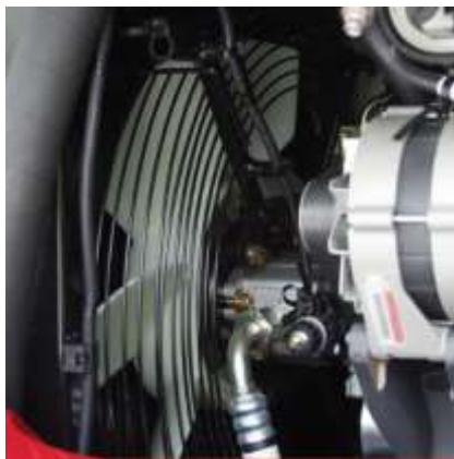
Radiatore side-by-side ad alta capacità, con sistema per ridurre le dispersioni energetiche.
