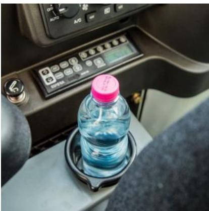
Porta bevande con riscaldamento o raffreddamento integrato con la rotazione della ghiera è possibile regolare la temperatura.
