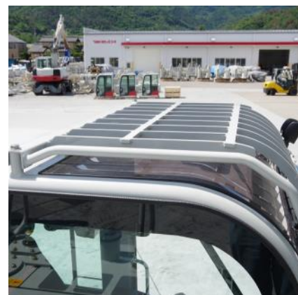
Griglia superiore cabina standard livello FOPS 2. Griglie frontali disponibili in opzione.
