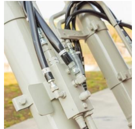
Valvole di sicurezza anticaduta su braccio e avambraccio con allarme di sollevamento. Riferimento sul certificato di omologazione della macchina.
