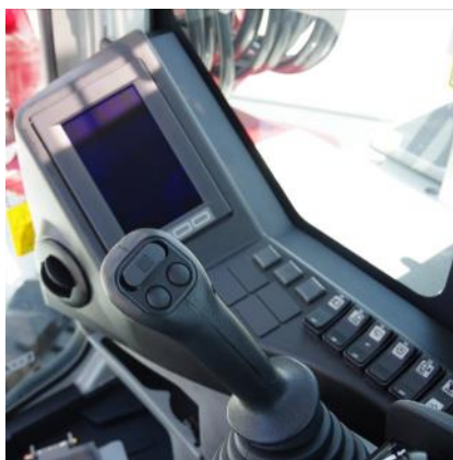
Controlli proporzionali per il controllo preciso delle attrezzature.
